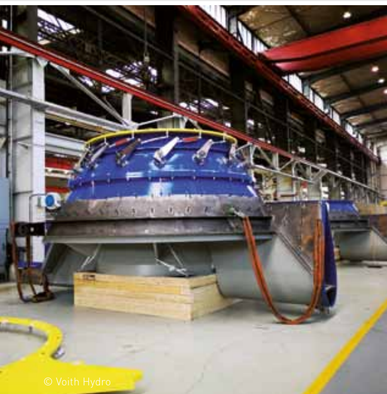
Stützschaufelring bei der Werksmontage
