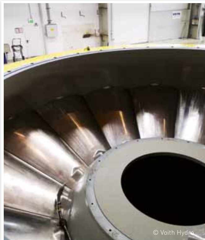
Stützschaufelring bei der Werksmontage
