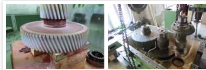
Komplett per Retrofit nachbearbeitetes Wasser-Turbinengetriebe.
