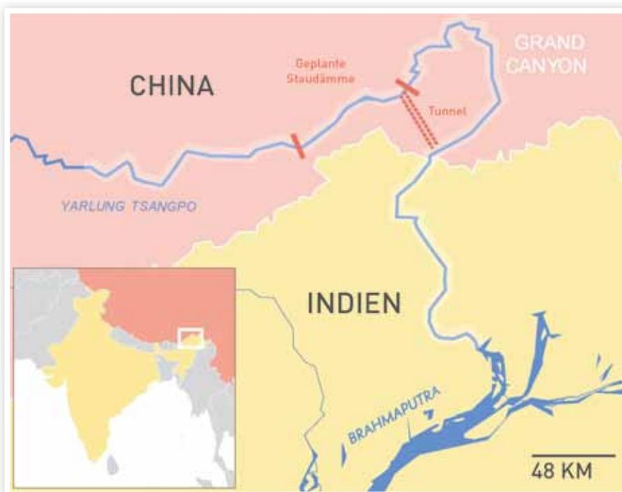
Schematische Darstellung des geplanten Wasserkraft-Projekts - YALE ENVIRONMENT 360
